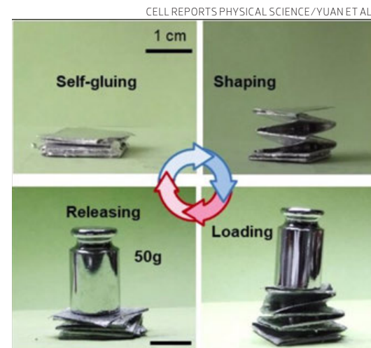
Una pieza de origami multifuncional construida con papel tratado con metal líquido.
