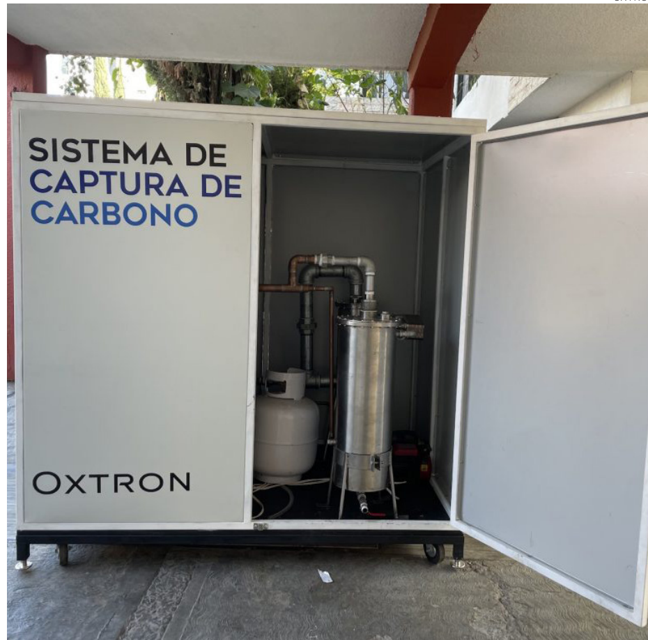
El sistema Oxtron de captura de CO 2 se conecta directamente a las chimeneas y otras fuentes de emisión de gases.
